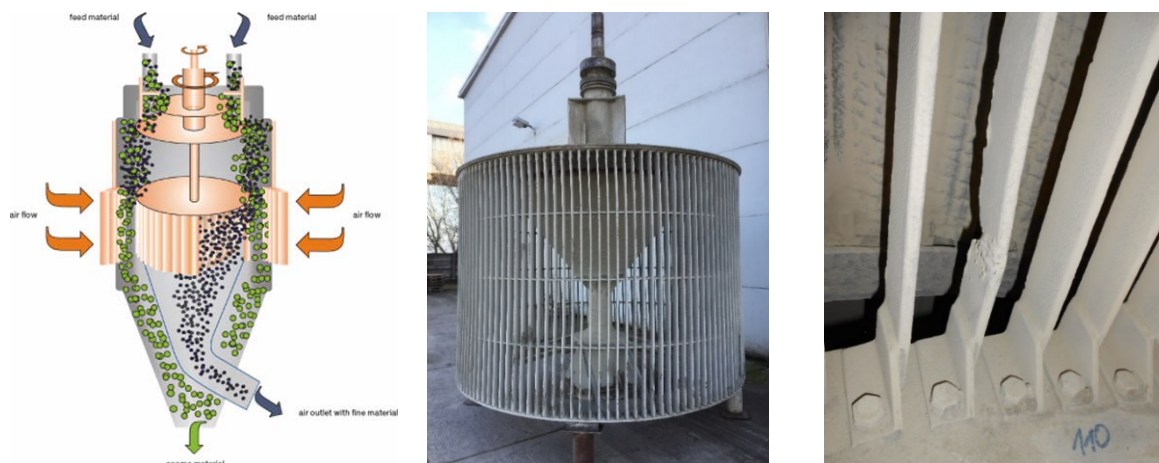
Abb. 12: Funktion des Sickers und Verschleiß am Sickerkorb
