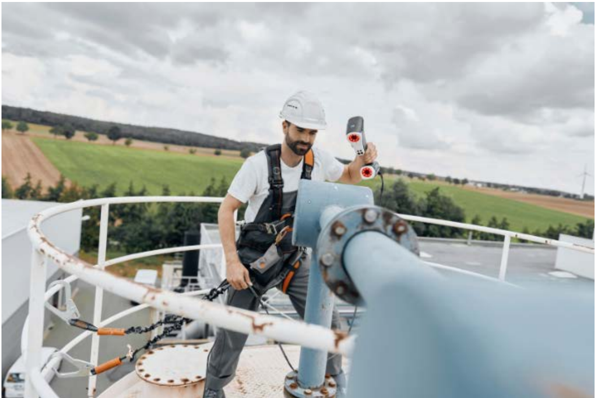
Abb. 3: Mobiler und vielseitig einsetzbarer 3D-Scanner T-SCAN hawk
