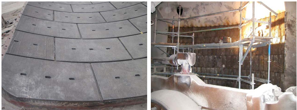
Abb. 11: Links: Schleißplatten für die Auskleidung zum Schweißen vorbereitet, Werksfoto WA Rechts: Mühlenauskleidung mit Schleißplatten und Einhänge-Technik, Werksfoto WA
