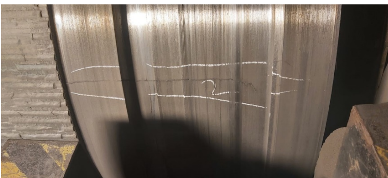
Abb. 3: Sichtbare Querrisse im Grundwerkstoff einer Walze nach Entfernung der Hartschicht (Werksfoto WA)
