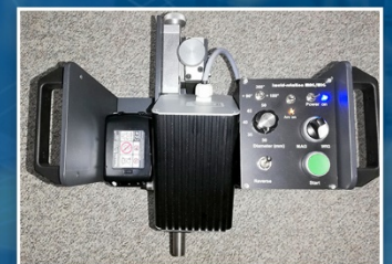
i-weld Rotation zum einschweißen von Buchsen und Stützen
