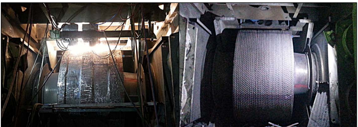
Abb. 5: Vor-Ort-Schweißung einer RPSMaxLife im eingebauten Zustand (WA Werksfoto)
