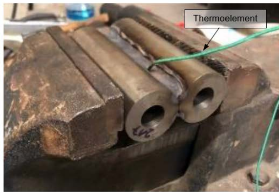
Abb. 2: Links: Versuchsaufbau mit eingebrachtem Thermoelement; rechts unten: Schematischer Aufbau einer geschweißten Probe; rechts oben: Schematischer Aufbau der Bruchprüfung.
